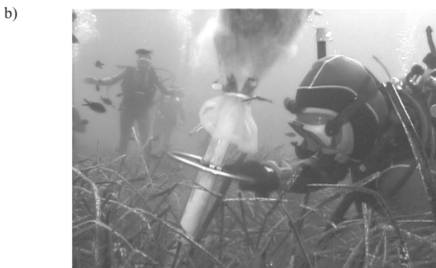
Fig. 12 - a) Schema di sorbona usata per fondi duri e fanerogame (da Giangrande et al. , 1986, modificato). b) Operatore subacqueo che utilizza la sorbona su P. oceanica .
